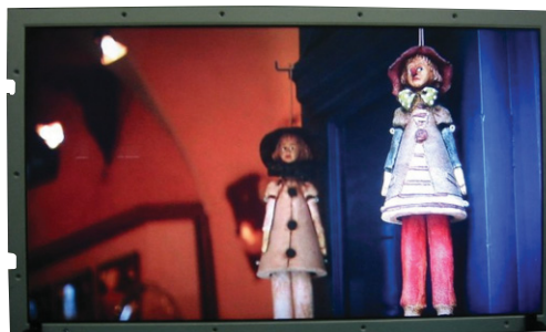
図 1. 32 型の OCB 液晶パネル — 高速 OCB 液晶と低温ポリシリコン TFT を融合した 32 型液晶パネル (1,366 × 768 画素) である。 32-inch-diagonal OCB-LCD panel (1,366 x 768 pixels)
